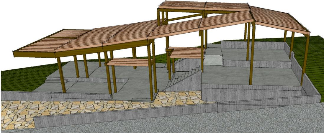
*Esquema estructural de la vivienda resuelto con madera*
